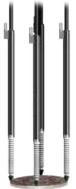
Sondas de 6 mm verificam a espessura de uma moeda
